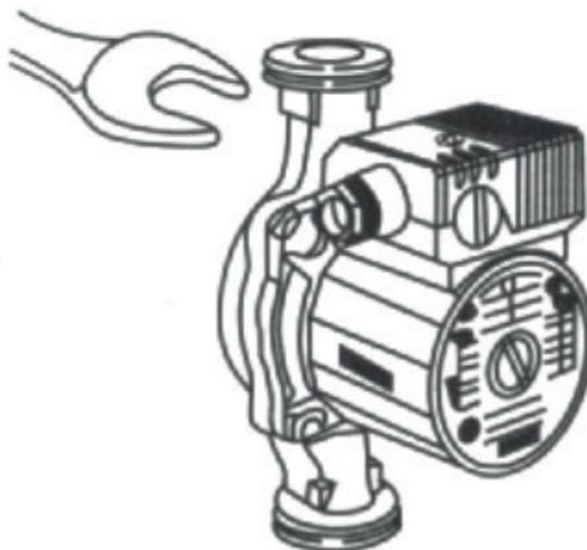
Daca pompa și încălzitorul de apă funcționează, dar nu funcționează încălzirea centrală, este posibil să existe aer în conductă sau în pompa care împiedică circulația lichidului. În mod normal aerisirea pompei de circulație se realizează automat după o anumită perioadă de timp, în caz contrar ar trebui să o aerisiți manual.
